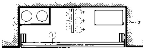
Abbildung 21: Schacht mit Mehrfachbelegung, [PROM2002]
