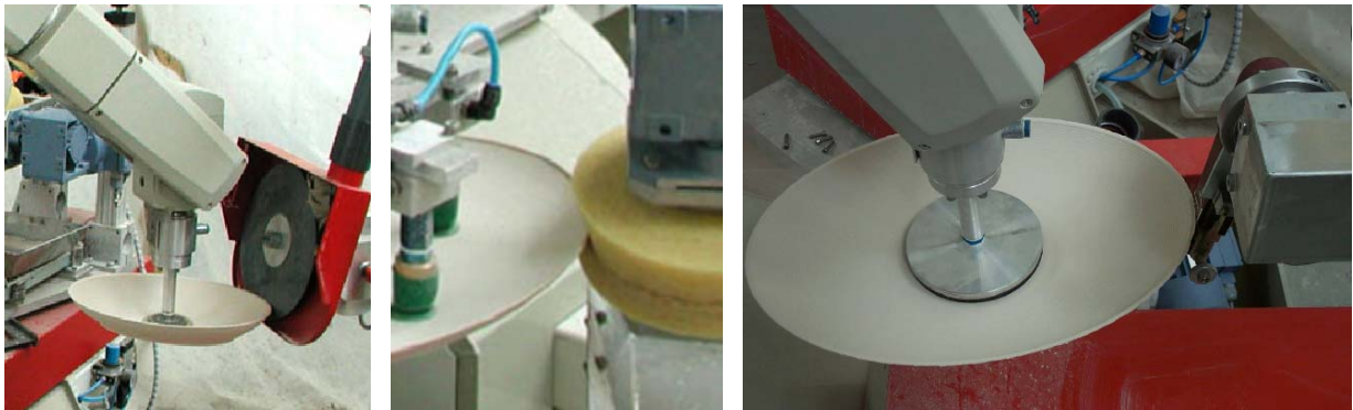
Bild 9.10: Auswahl an Werkzeugen für die Konturbearbeitung der Porzellanprodukte
