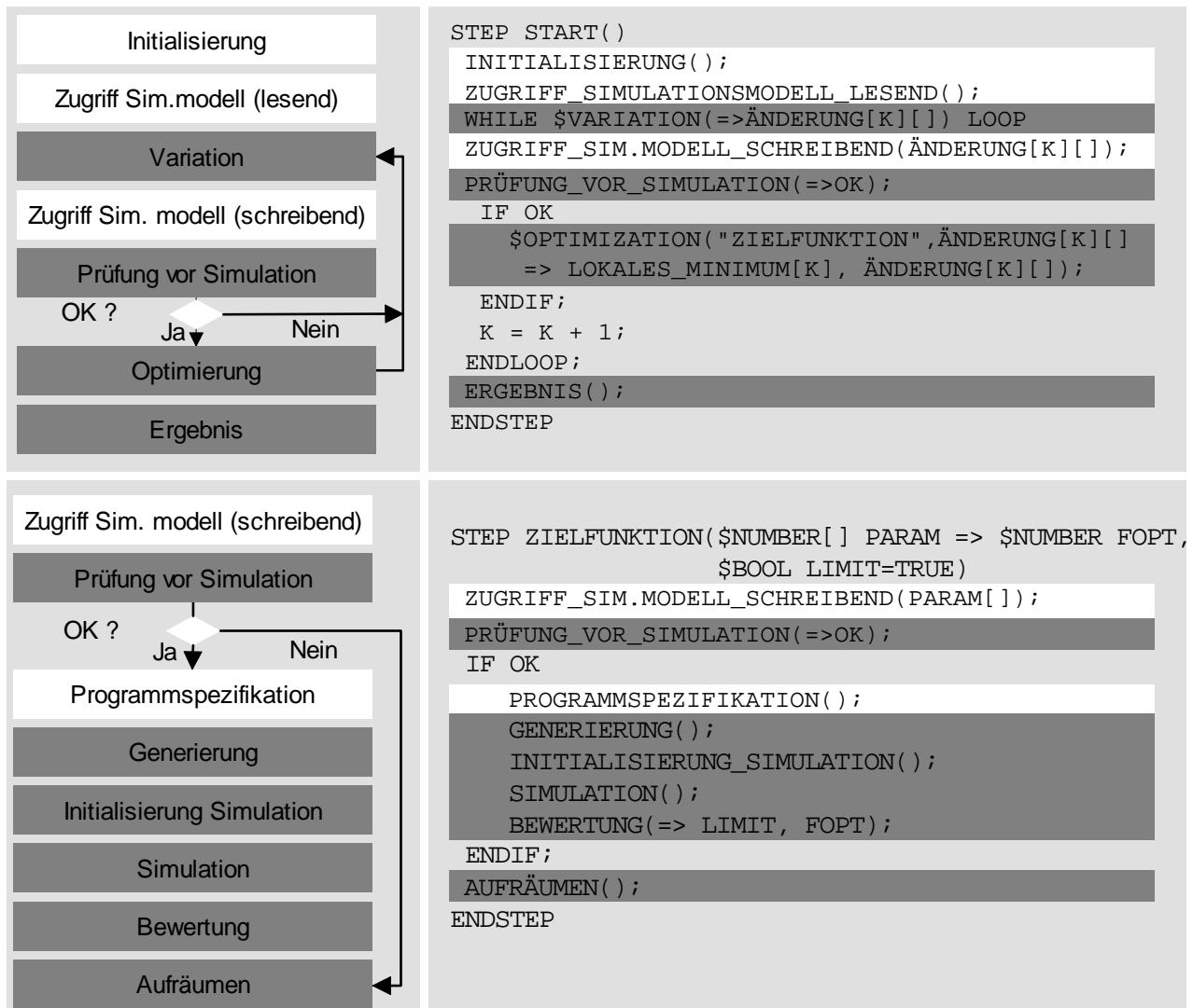
Bild 5.14: Startschritt und Zielfunktionsschritt der Schablone für die Layoutoptimierung
