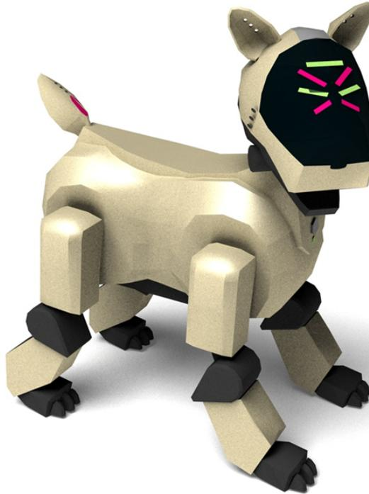
Abbildung 5.1: Der vierbeinige Laufroboter Sony Aibo ERS 210.
