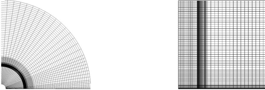
Abbildung 1.3: Prototypische Gitterverfeinerung für die numerische Simulation einer Akkretionsscheibe
