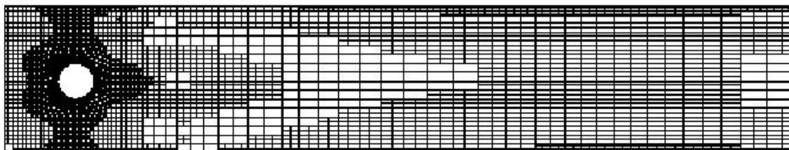
Abbildung 1.5: Quasi-optimales Gitter für eine Zylinderumströmung aus [63]
