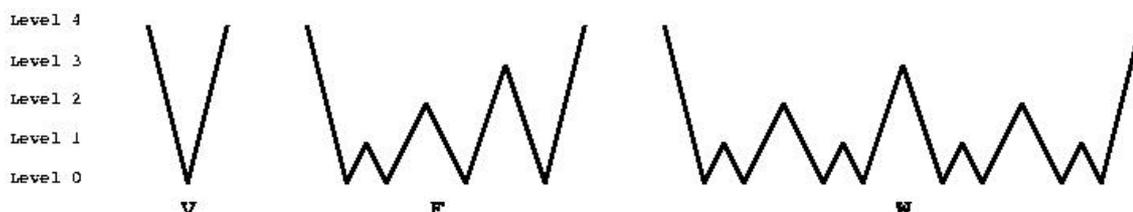
Abbildung 3.6: Verschiedene Mehrgitterzyklen
