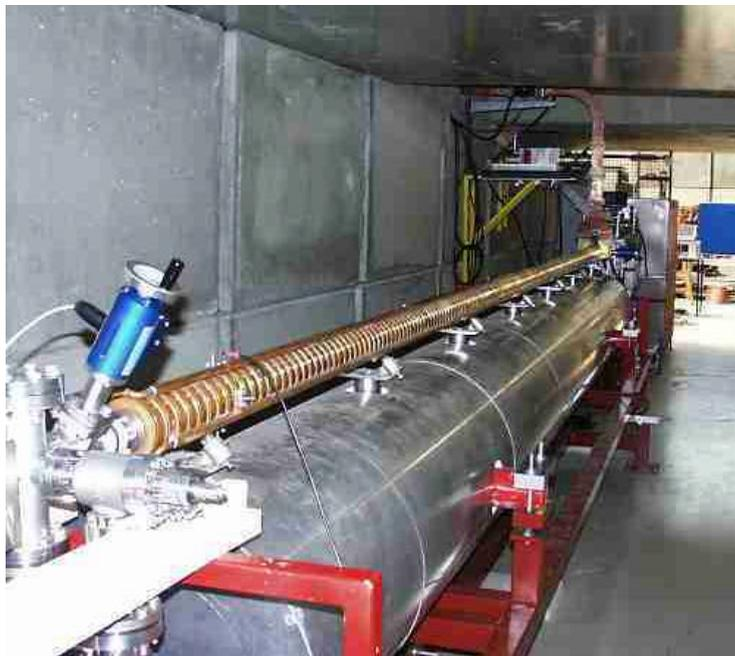
*Abbildung 12-4: Der DELTA-Injektor-Linearbeschleuniger*
