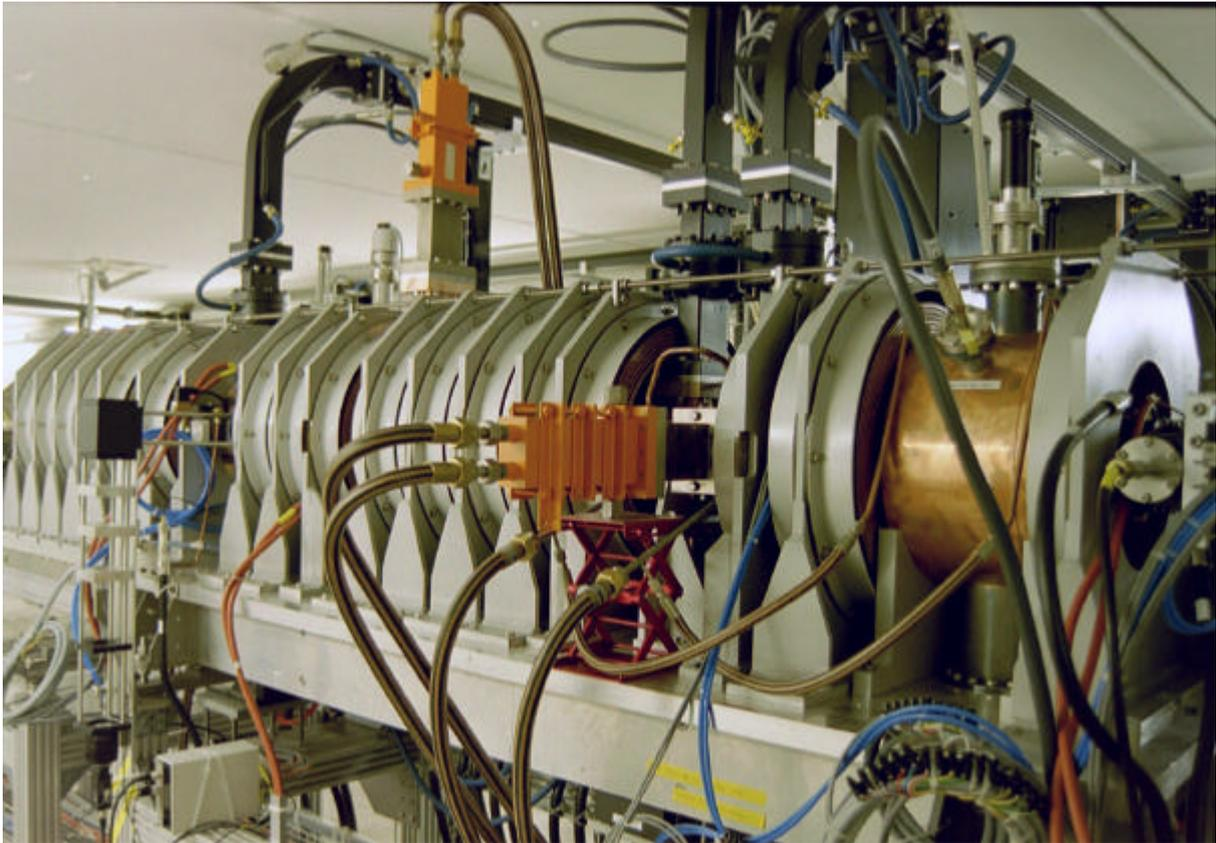
*Abbildung 9-19: Fokussiersystem der Bunchingsektion*
