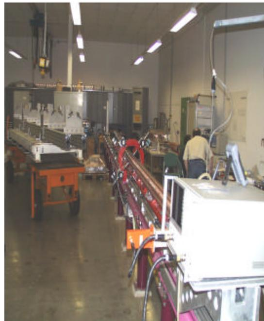
Abbildung 9-14: Ansicht der S-Band-Struktur vor und während des Tunings
