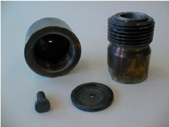
**Abb. 1.3.a.:** Ein in seine Bestandteile zerlegter Schmelzautoklav großer Bauart.
