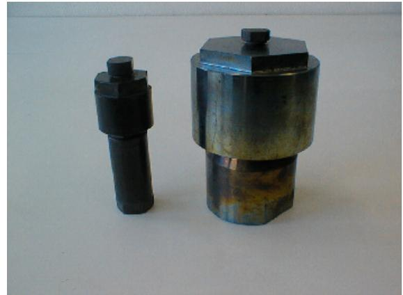
**Abb. 1.3.b.:** Vergleich zwischen einem Schmelzautoklav herkömmlicher mit einem großer Bauart.
