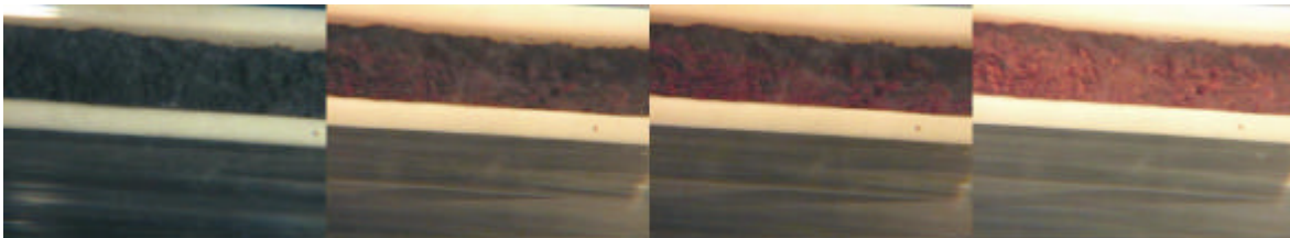
Abb. 5.11: \text{PbO}_2 unmittelbar vor dem Versuch (links) und das Reaktionsprodukt nach Ablauf des Versuches (rechts) bei Raumtemperatur
