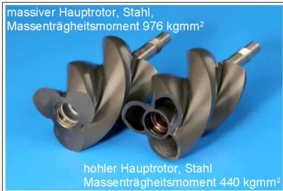
Bild 9.10: Ausführung des Hauptrotors als massiver und hohler Rotor, Rotorwerkstoff Stahl
