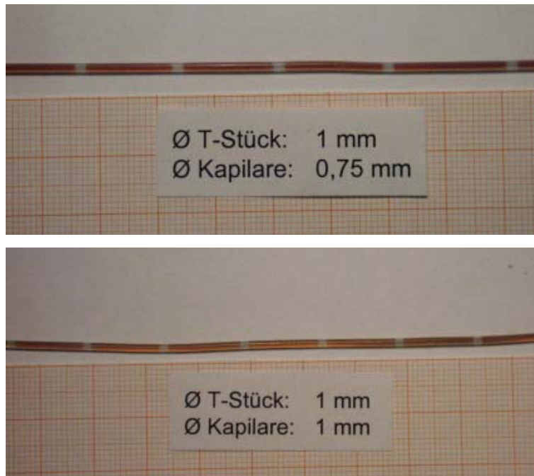
Abbildungen 4-8a - b: Aufnahmen der zweiphasigen flüssig-flüssig Pfropfenströmung bei unterschiedlichen Durchmessern der Kapillare ( \varnothing T-Stück = 1 mm, \varnothing Kapillare = 0,75 mm - 1 mm)
