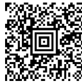
Abbildung 13: Beispiel für einen Aztec-Code Quelle: Eigenerstellung
