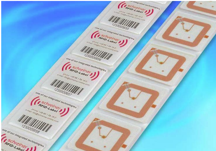
Abbildung 6: Plasto-Label von Schreiner LogiData Quelle: [30]
