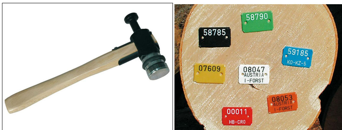
Abbildung 2: Anschlaghammer und Markierplättchen Quelle: [15]
