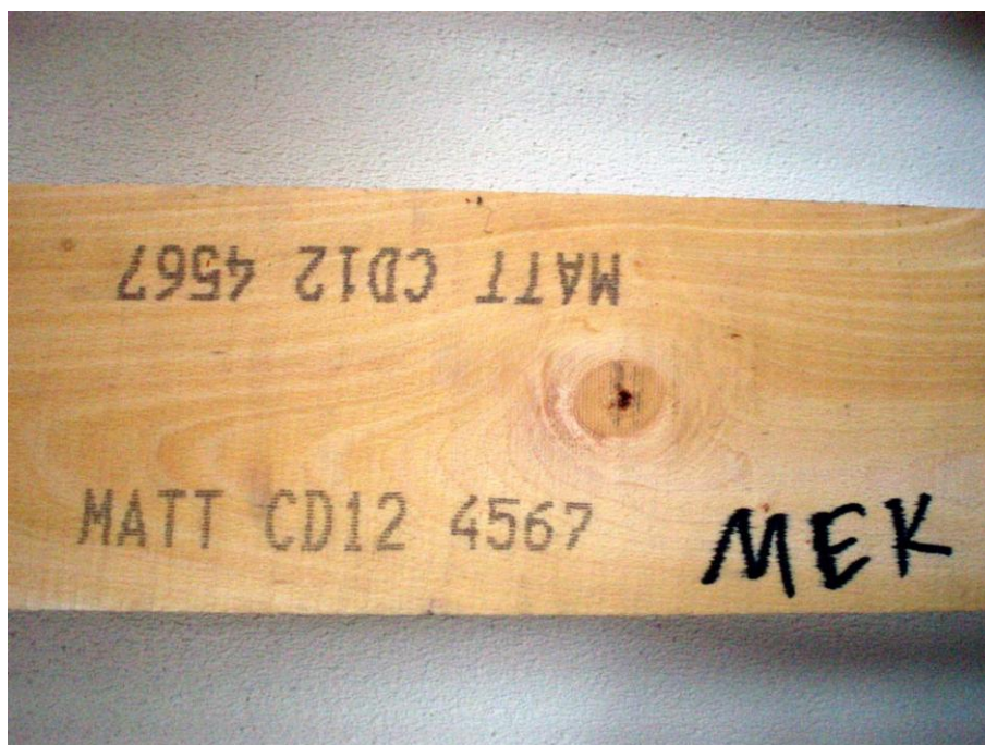
Abbildung 70: Applizierte OCR-Codes mit MEK-Tinte Quelle: Eigenerstellung
