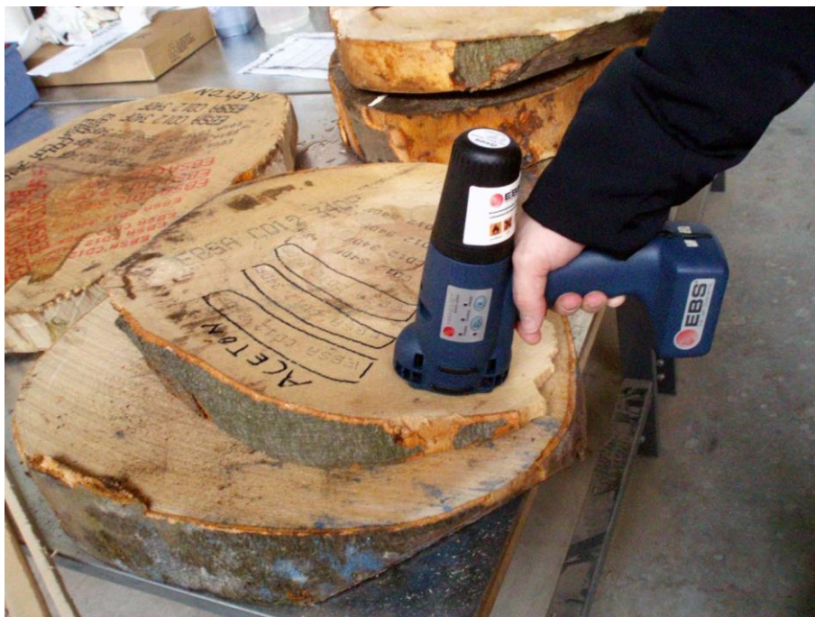
Abbildung 65: Applikation von OCR-Codes mittels Handapplikator Quelle: Eigenerstellung
