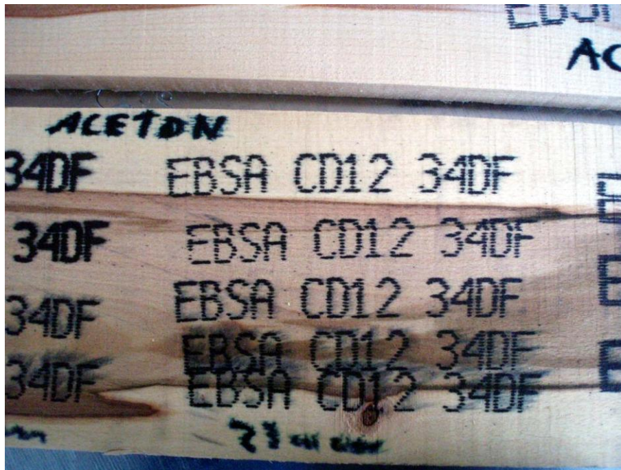
Abbildung 69: Applizierte OCR-Codes mit Aceton-Tinte Quelle: Eigenerstellung
