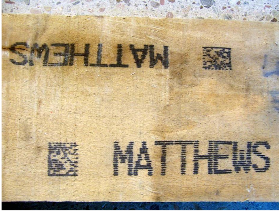
Abbildung 74: MEK-Tinte nach der Trocknung Quelle: Eigenerstellung
