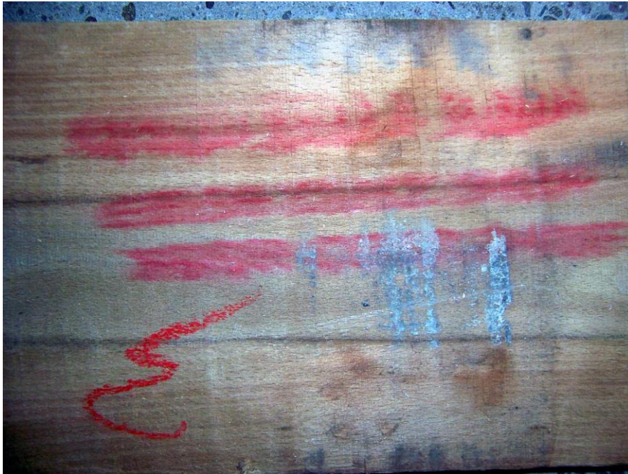
Abbildung 71: Wasserbasierte Kennzeichnung nach der Trocknung Quelle: Eigenerstellung
