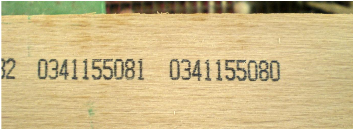
Abbildung 89: Applizierte OCR-Codes auf Trockenholz mit 50 m/min (Beispiel) Quelle: Eigenerstellung
