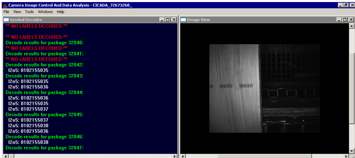
Abbildung 92: Dekodierung von Barcodes auf Trockenholz mit 30 m/min Quelle: Eigenerstellung
