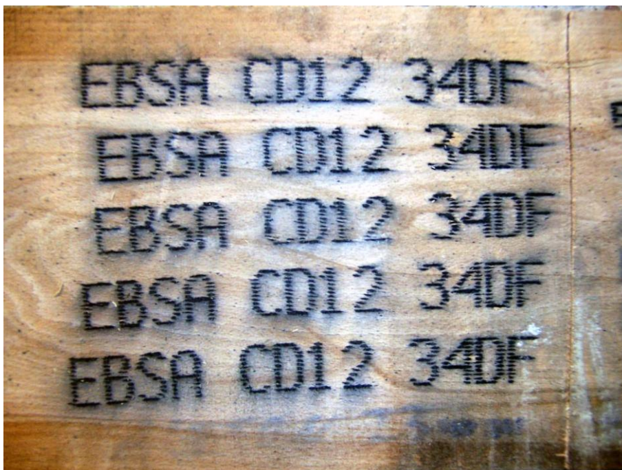
Abbildung 73: Aceton-Tinte nach der Trocknung Quelle: Eigenerstellung
