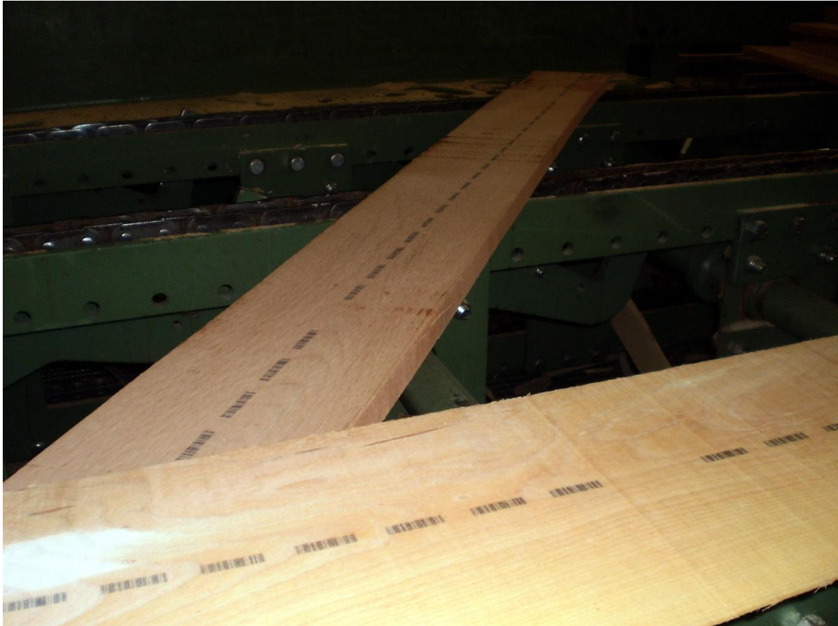
Abbildung 99: Auf sägefrisches, feuchtes Holz applizierte Barcodes (Beispiel) Quelle: Eigenerstellung
