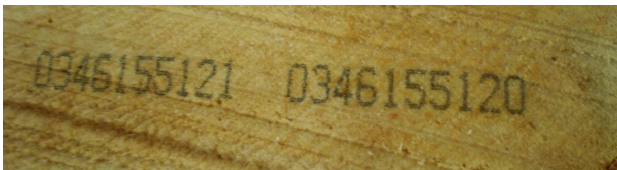
Abbildung 98: Applizierte OCR-Codes auf Stirnseite mit 30 m/min Quelle: Eigenerstellung
