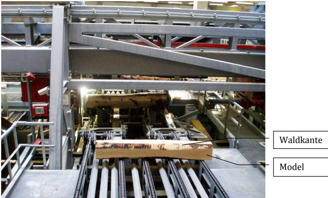
Abbildung 26: Endprodukt der Blockbandsäge – das Model Quelle: Eigenerstellung
