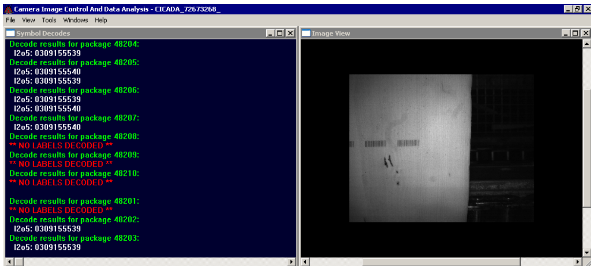
Abbildung 100: Dekodierung von Barcodes auf sägefrischem Holz mit 30 m/min
