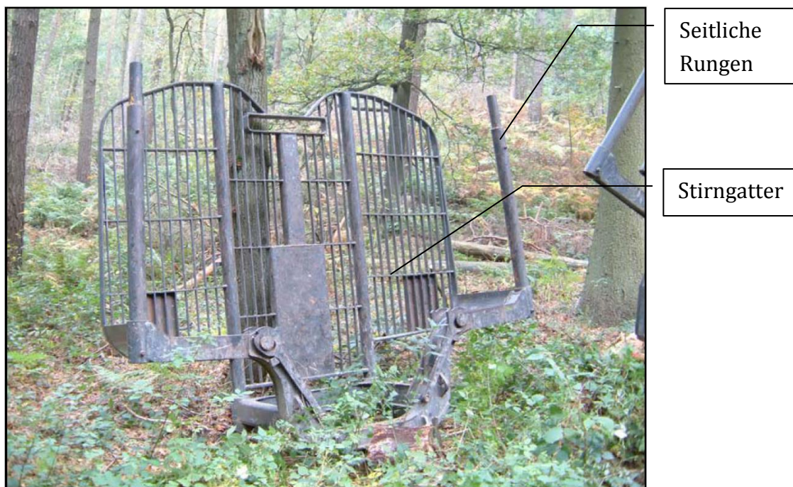
Abbildung 58: Für die Versuche genutztes Stirngatter eines Forwarders Quelle: Eigenerstellung
