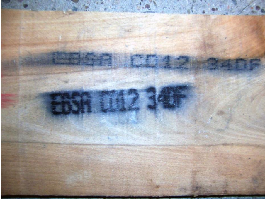
Abbildung 72: Ethanol-Tinte nach der Trocknung Quelle: Eigenerstellung
