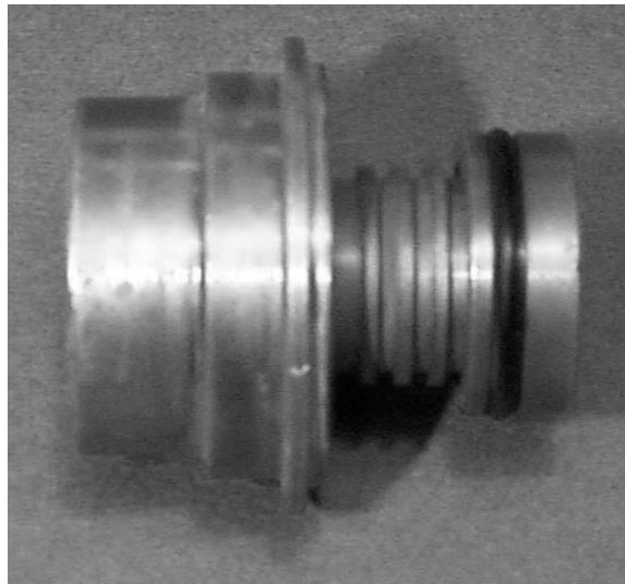
Abbildung 58: Spritzdüse, Gesamtlänge 33 mm
