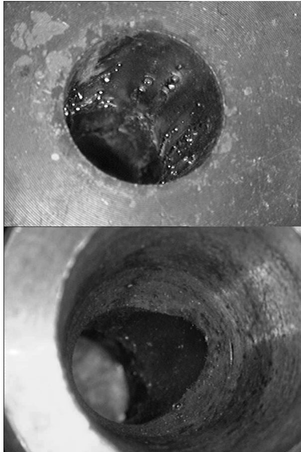
Abbildung 60: Öffnung einer verschlissenen Düse (Düsenverschleiß 1) oben: Ansicht von vorne (Austritt der Gasströmung), \varnothing 6 mm unten: Ansicht von hinten, \varnothing 13 mm
