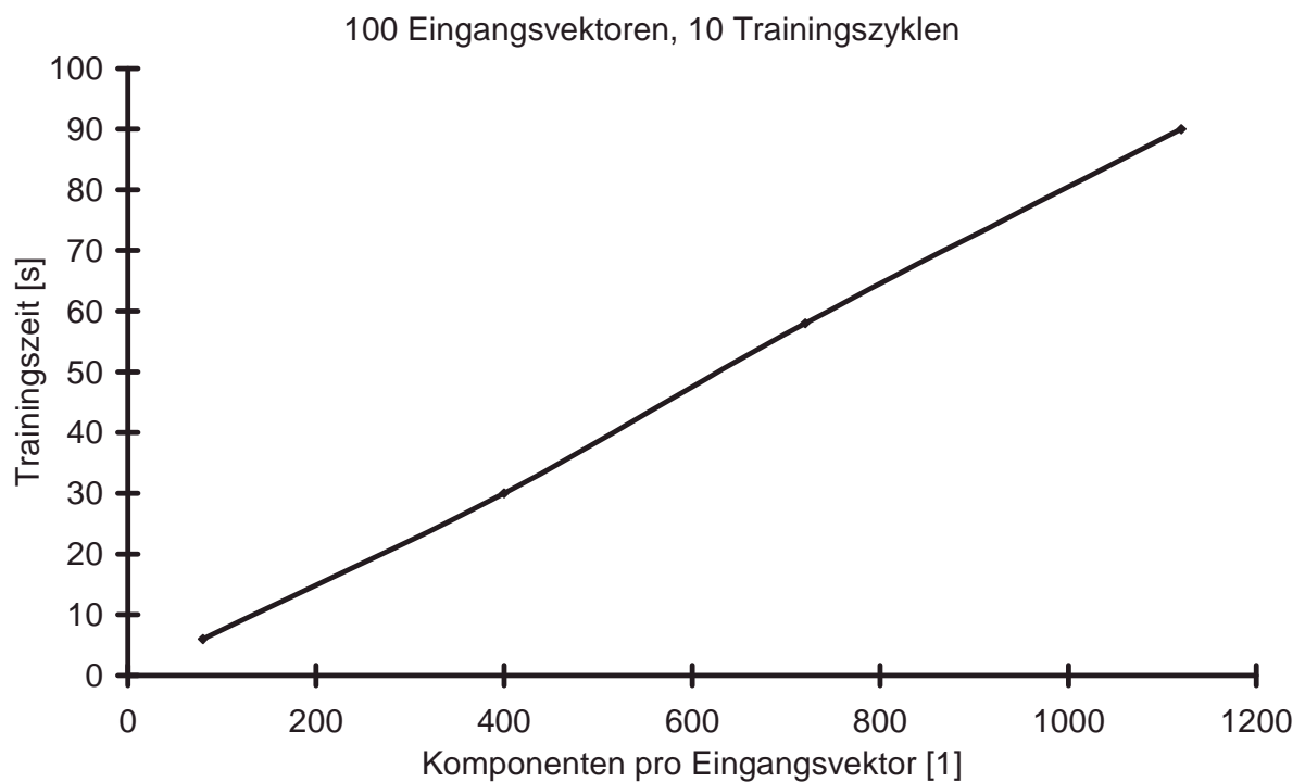
Abbildung 74: Abhängigkeit der Trainingszeit von der Größe der Eingangsvektoren
