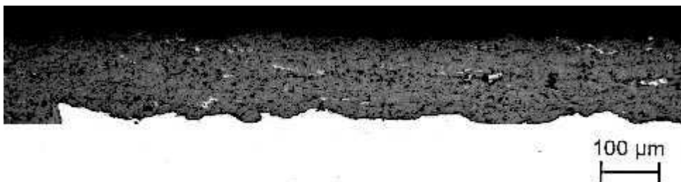
Abbildung 63: Mikroskopische Aufnahme (Querschliff) einer Chromoxidschicht, optimale Beschichtungsparameter, APS (I=500 A), 1200 HV 0,1 , 3 % Porosität
