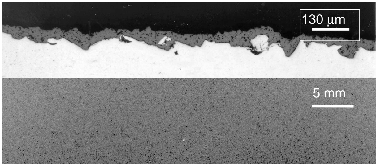
Abbildung 32: Mikroskopische Aufnahme (Querschliff, oben) und Oberflächenaufnahme (unten) bei I = 500 A, Chromoxid, APS
