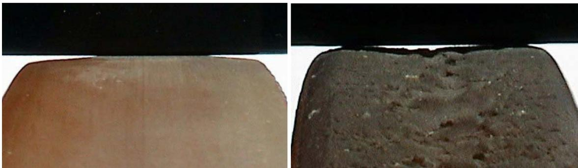
**Abb. 7.34:** Darstellung der Abhängigkeit des Verschleißverhaltens von äußeren Einflüssen. Links Versuch mit Wasser, rechts mit Sand als Zwischenstoff.
