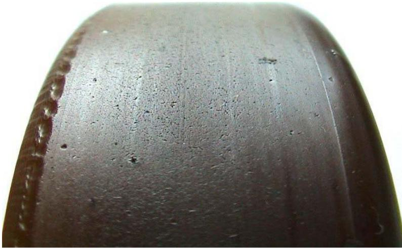
**Abb. 7.18:** Vulkollanrad mit einer 92 Shore-A-Bandage und 100 mm  $\varnothing$  nach 24 h Versuchsdauer unter Einwirkung von Metallspänen und Schneid-Kühl-Emulsion als Zwischenstoff.
