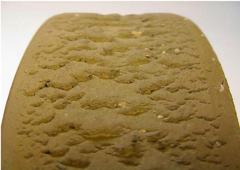
**Abb. 7.10:** Vulkollanrad mit einer 80 Shore-A-Bandage und 100 mm  $\varnothing$  nach 24 h Versuchsdauer unter Einwirkung von Sand als Zwischenstoff.
