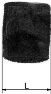
**Abb 5.3:** Statischer Kontaktflächenabdruck eines Rades mit 100 mm Durchmesser und 85 Shore-A Bandage unter Einwirkung von 3.000 N Normalkraft; Kontaktflächenlänge  $L = 22$  mm
