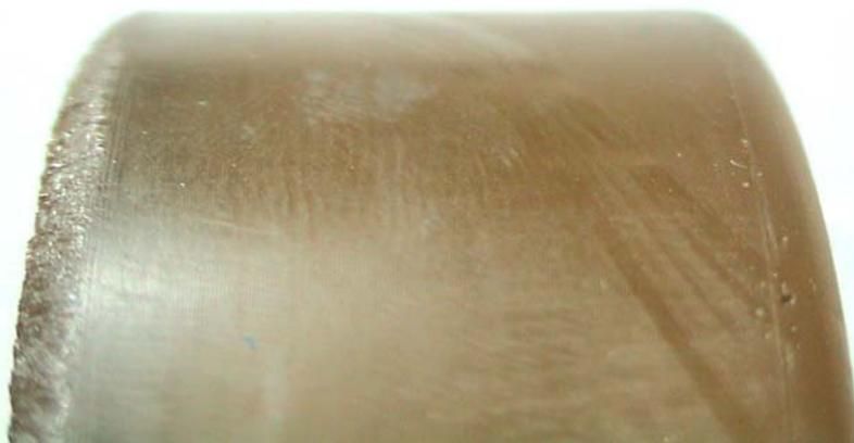
**Abb. 7.19:** Vulkollanrad mit einer 85 Shore-A-Bandage und 100 mm  $\varnothing$  nach 24 h Versuchsdauer unter Einwirkung von Schneid- Kühl- Emulsion als Zwischenstoff.
