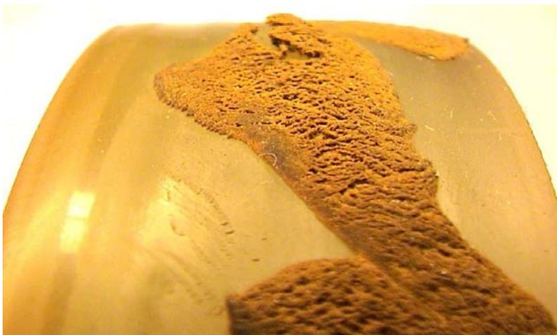
**Abb. 7.7:** Vulkollanrad mit einer 80 Shore-A-Bandage und 100 mm  $\varnothing$  nach 24 h Versuchsdauer unter Einwirkung von Wasser als Zwischenstoff.
