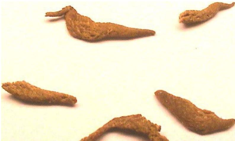
**Abb. 7.6:** Abgespülte Abriebpartikel des Rades aus **Abb. 7.5**.
