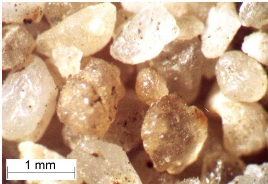
**Abb 5.4:** Mittelfeiner Quarzsand zum Einsatz als Zwischenstoff.
