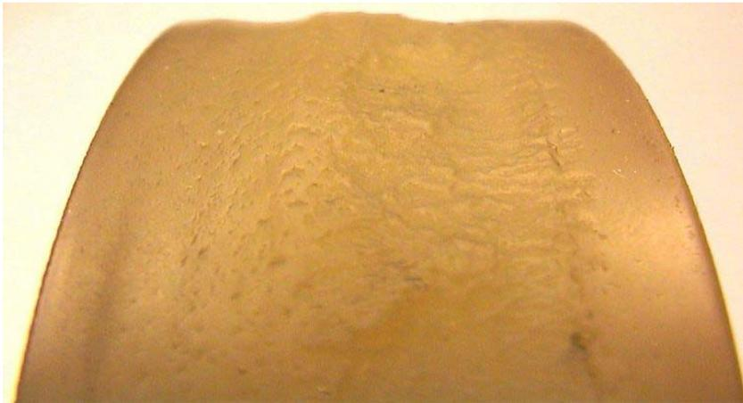
**Abb. 7.13:** Vulkollanrad mit einer 85 Shore-A-Bandage und 100 mm  $\varnothing$  nach 24 h Versuchsdauer unter Einwirkung von Wasser mit Sand als Zwischenstoff.
