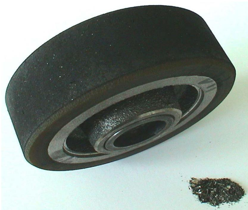
**Abb. 7.17:** Vulkollanrad nach der Untersuchung unter Einwirkung von Metallspänen mit den aus der Bandage entfernten Einlagerungen.
