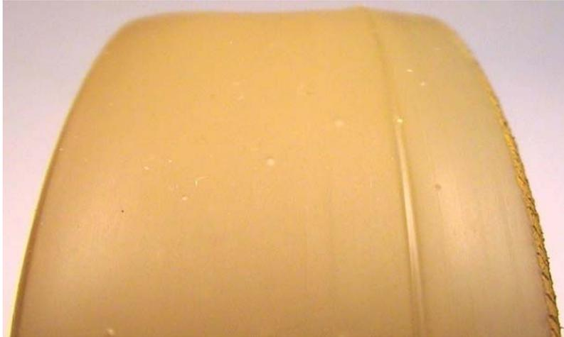
**Abb. 7.5:** Vulkollanrad mit einer 92 Shore-A-Bandage und 100 mm  $\varnothing$  nach 24 h Versuchsdauer unter Einwirkung von Wasser als Zwischenstoff.
