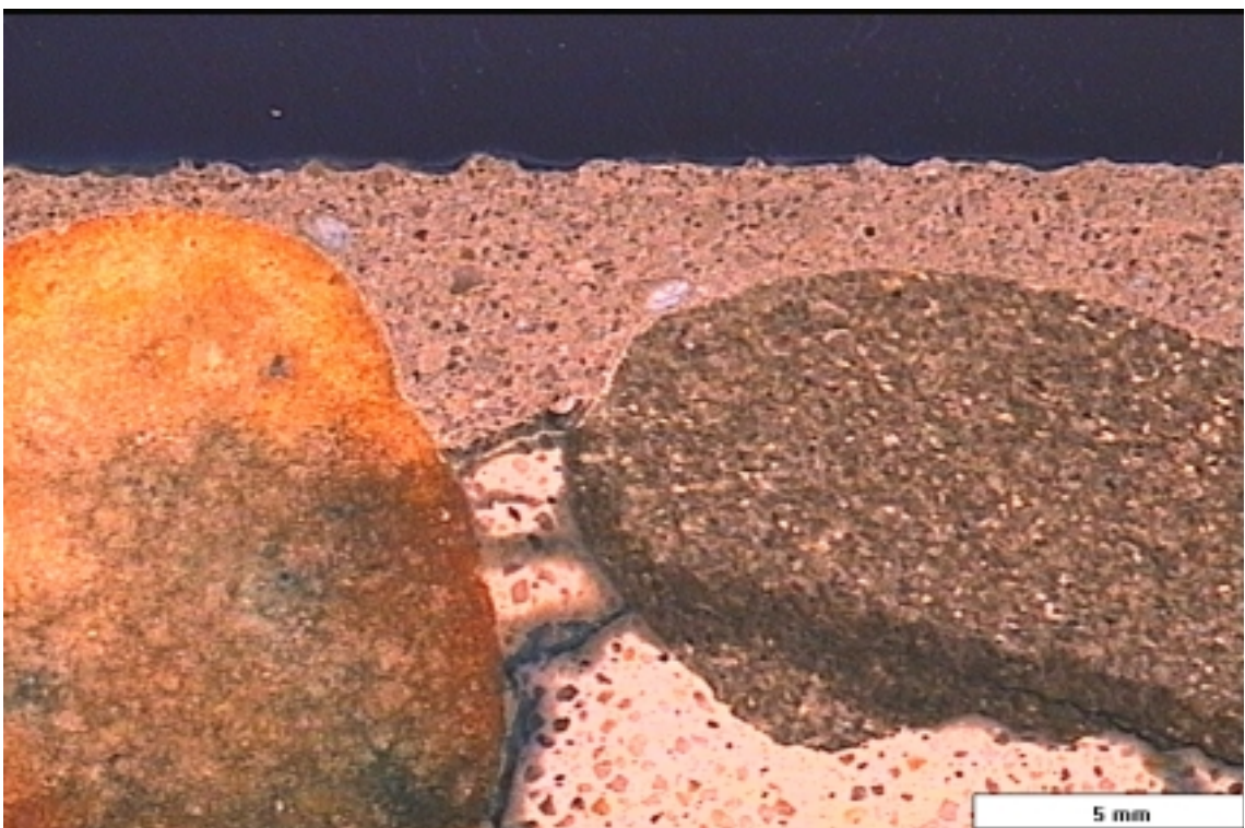
Abb. 43: Bündig gespachtelter Waschbetonverbundkörper mit OS-Beschichtung
