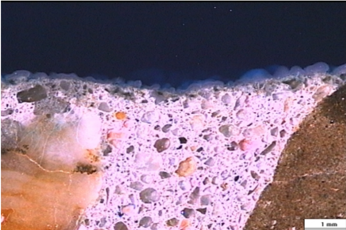
Abb. 38: Tropfenbildung der OS-Beschichtung bei Spritzapplikation
