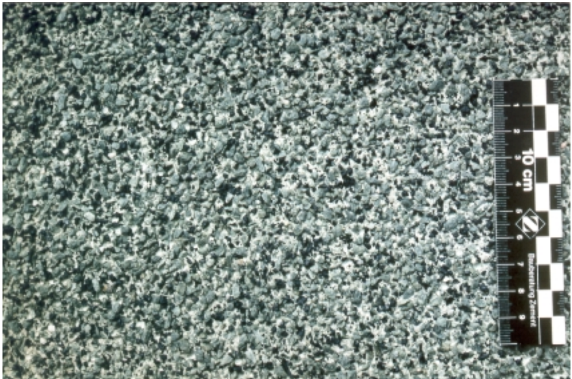
Abb. 2: Feingewaschene Betonoberfläche, Rauhtiefe ca. 2 mm
