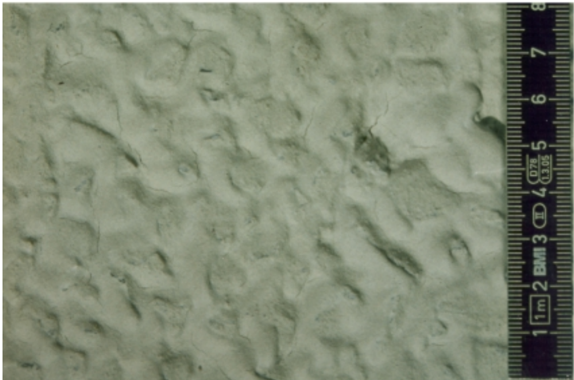
Abb. 19: Rißbildung an einer elastischen Schlämme
