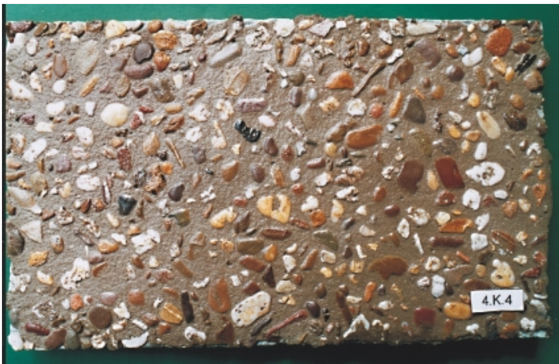
Abb. 40: Glänzende Oberfläche der Beschichtung OS 4-4
