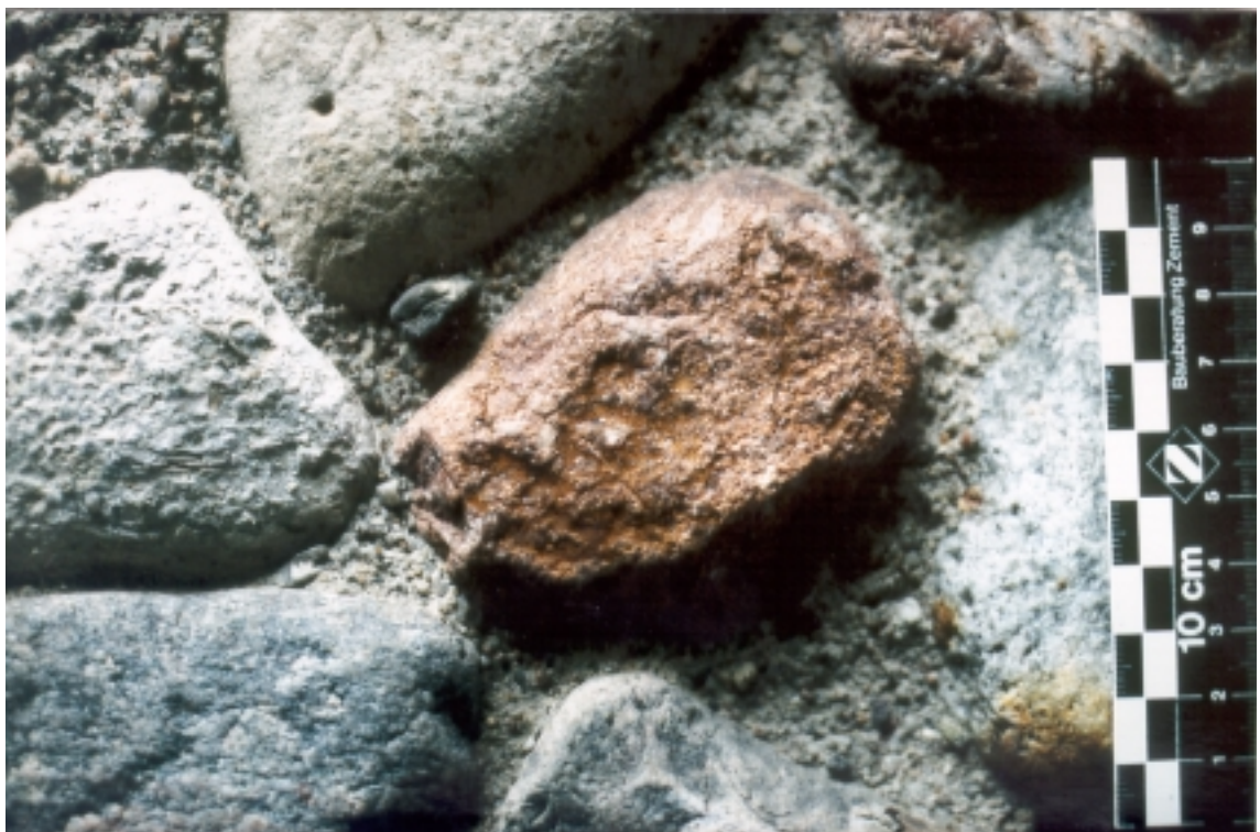
Abb. 3: im Sandbettverfahren ausgewaschene Betonoberfläche, Rauhtiefe ca. 50 mm
