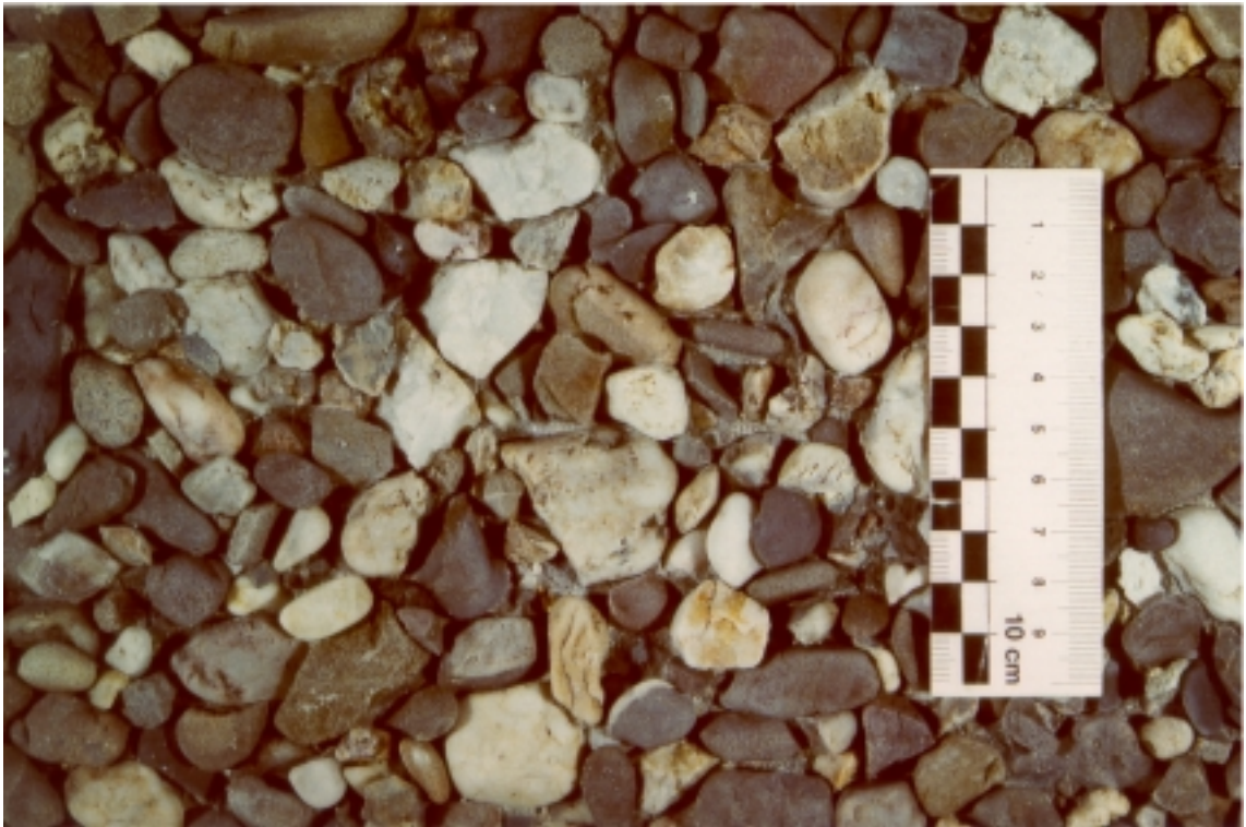
Abb. 33: Waschbetongrundkörper Kies, Rauhtiefe ca. 6 mm
