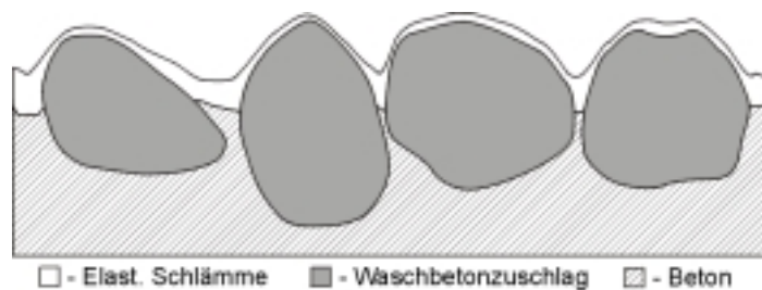
Abb. 15: Waschbetoninstandsetzung Variante I, "elast. Schlämme"
