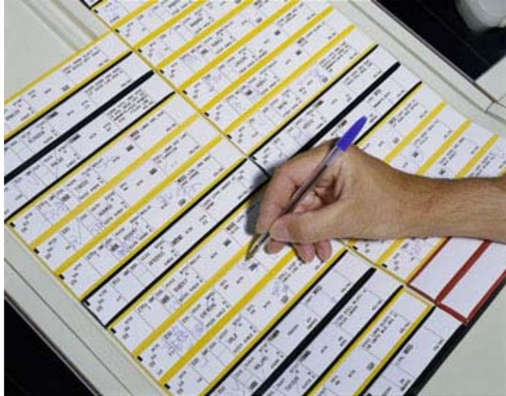
**Abbildung 3-5: Flight Progress Strip (DFS, 2003)**
