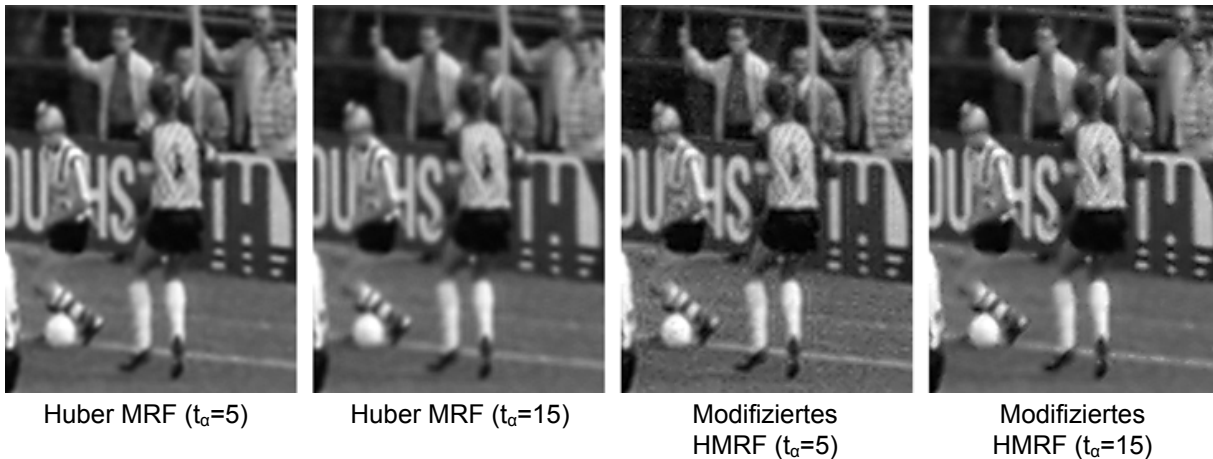
Abbildung 6.12: Eigenschaften des Huber MRF Bildmodells und des modifizierten HMRF auf das Ergebnis bei unterschiedlichen Schwellwerten \alpha
