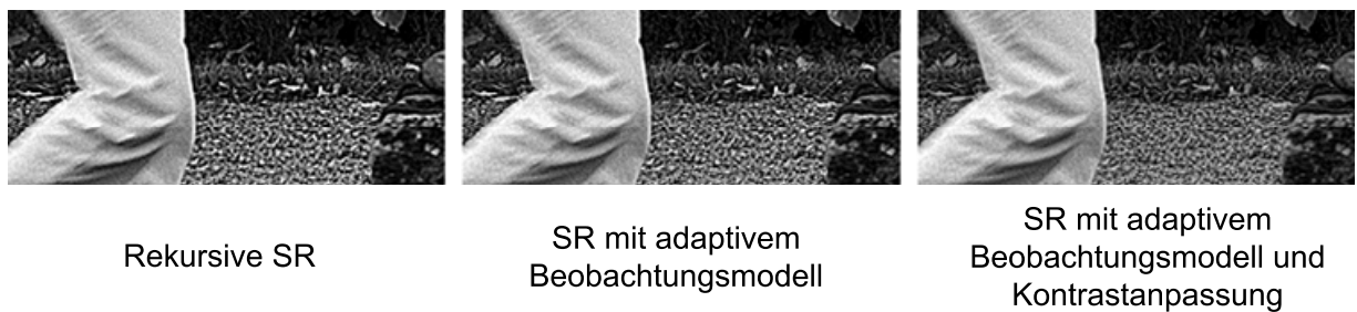
Abbildung 6.19: Anwendung der minimalen lokalen Varianzschätzung zur Kontrolle der Schärfe im Super-Resolution Algorithmus
