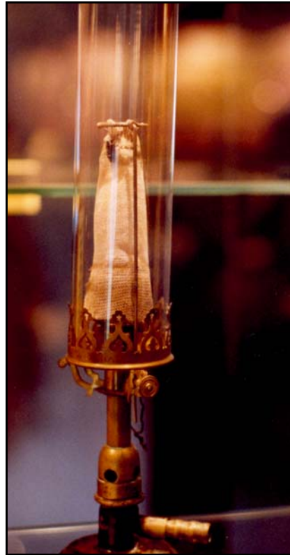
Abbildung 93 Photographie eines Auerbrenners aus dem Auer-von-Welsbach-Museum in Treibach-Althofen (Kärnten). Benannt wurde der Brenner nach dem österreichischen Chemiker Carl Auer von Welsbach (1858-1929). In einer österreichischen Museumsankündigung 1999 wird Carl Auer von Welsbach als größtes Genie Österreichs bezeichnet.
