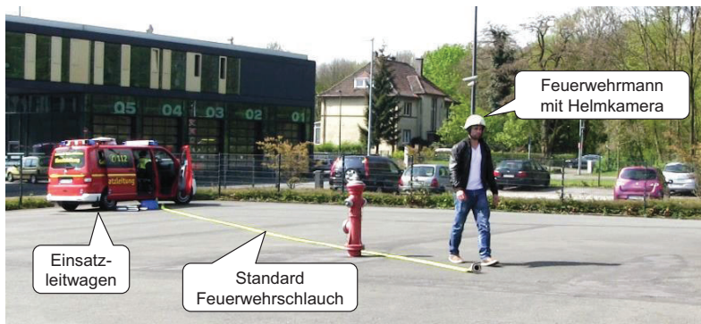
Abbildung 6.9: Videoübertragung von einer Helmkamera zum ELW
