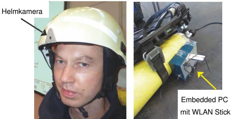
Abbildung 3.2: Prototyp zur Videoübertragung von einer Helmkamera
