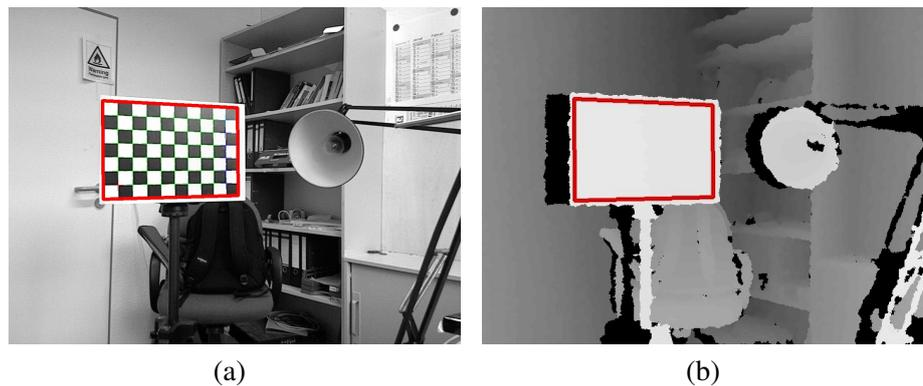
**Abbildung 5.22:** Aufnahmen einer Szene mit dem Kinect Sensor. Das RGB-Kamerabild (nach Graustufenkonvertierung) und das zugehörige Tiefenbild sind in (a) und (b) dargestellt. Der relevante Bereich in beiden Bildern ist durch das rote Polygon verdeutlicht. Für Tiefenwerte, die innerhalb des Polygons liegen, können Referenzmessungen online berechnet werden.
