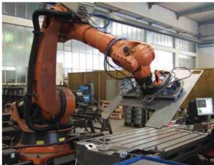
Abbildung 10: Der RAAS-Roboter beim Einmessen eines Schweißteils [Hüp06]
