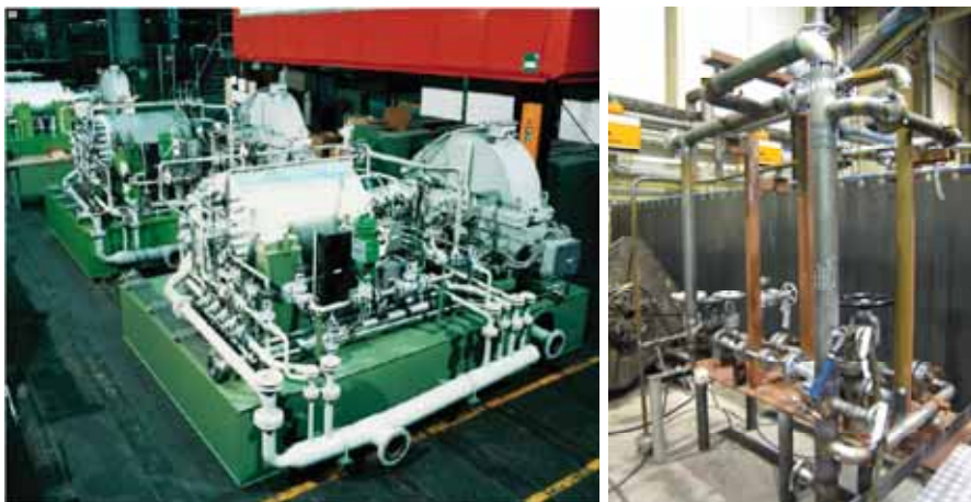
Abbildung 1: Rohrkonstruktionen für Turbomaschinen [MAN]
