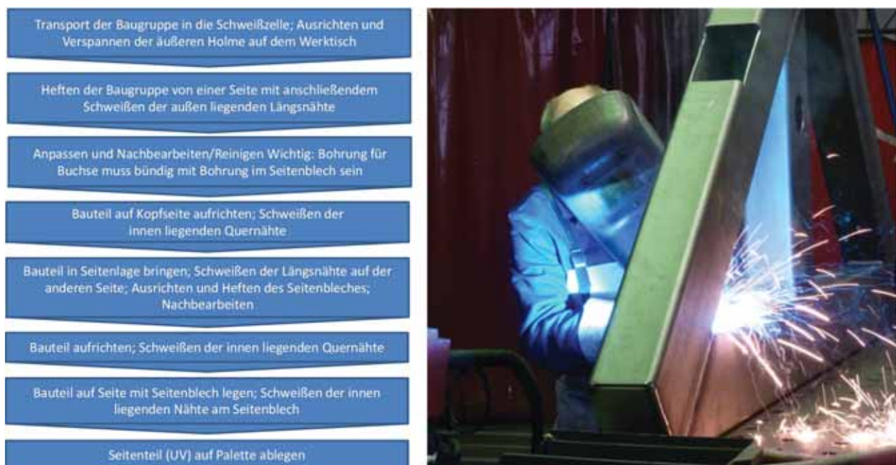
Abbildung 19: Schweißen einer Baugruppe [Böcker]
