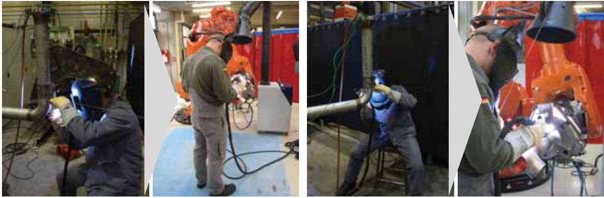
Abbildung 41: Schweißablauf Rohrbaugruppe im Vergleich: Manuell ↔ Roboterassistiert
