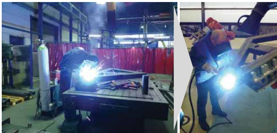
Abbildung 39: Schweißablauf Rahmenbauteil im Vergleich: Manuell ↔ Roboterassistiert
