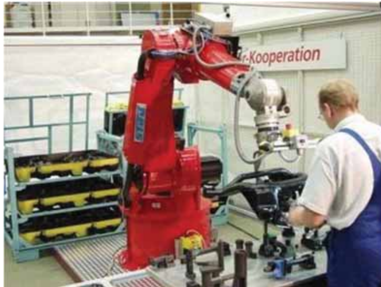
Abbildung 8: Arbeitsplatz des Roboterassistenzsystems PowerMate [Sch05]
