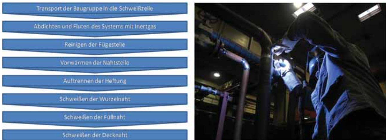
Abbildung 18: Schweißen einer Baugruppe [MAN]
