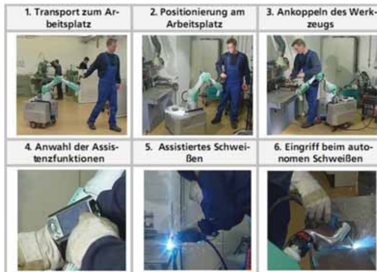
Abbildung 7: Prozessschritte beim Schutzgasschweißen mit dem rob@work [Hel06]
