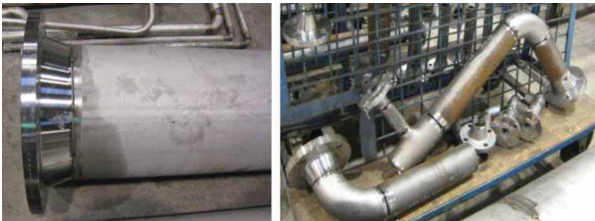
Abbildung 11: Geheftete Rohrkonstruktionen [MAN]
