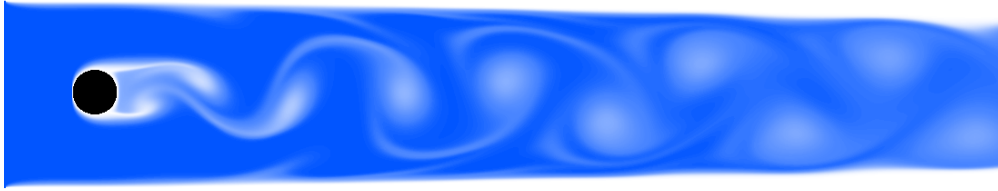
Abbildung 8.1: Die Ausbildung einer Kármánschen Wirbelstraße hinter einem Zylinder in 2D. Die Simulation wurde mit den LBM-Strömungs- und Transportsimulationen in Boltzplatz durchgeführt. Für die Visualisierung der sich periodisch ablösenden Wirbel wird ein passiver Skalar verwendet. Die Konzentration des passiven Skalars ist in Blau dargestellt.
