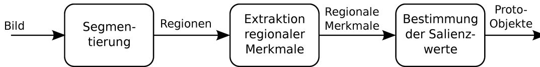
Abbildung 5.1.7: Bestimmung der Proto-Objekte mittels Segmentierung auf dem Eingabebild und Extraktion regionaler Salienzmerkmale.
