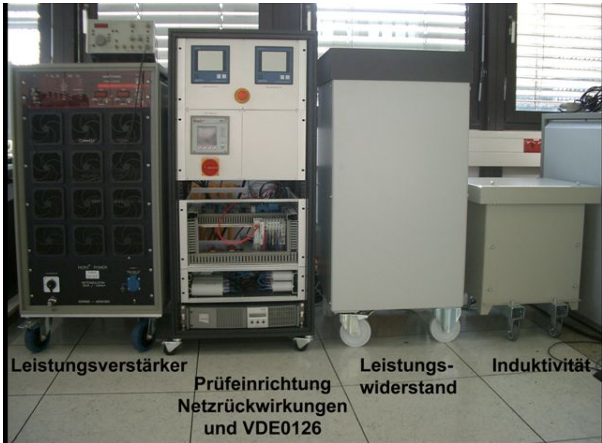
Abb. 11: Testeinrichtung für Wechselrichter
