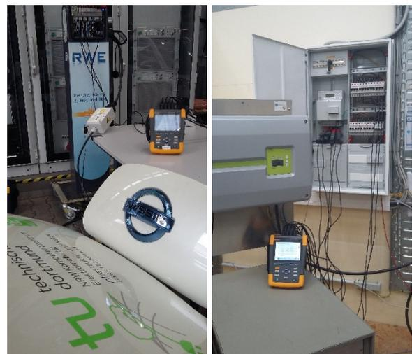
Ausspeisepunkt über SyncMeter an öffentlicher Ladeinfrastruktur (links), Einspeisepunkt über intelligentes Messsystem mit PV-Wechselrichter (rechts)
