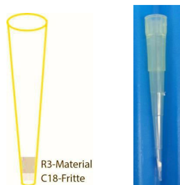
Abbildung 3-3: Schematische Abbildung (links) und Foto (rechts) einer selbst hergestellten C18-Säule zum Entsalzen.
