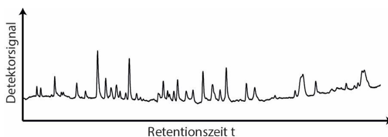
Abbildung 1-8: Ein Chromatogramm zeigt die detektierten Analyten abhängig von ihrer Retentionszeit (Abbildung erstellt mit Adobe Illustrator mit selbst aufgezeichnetem Chromatogramm, Verena Tinnefeld).
