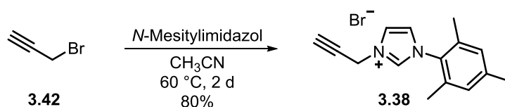
Schema 3.24: Syntheschema zur Darstellung des Imidazoliumsalzes 3.38 .
