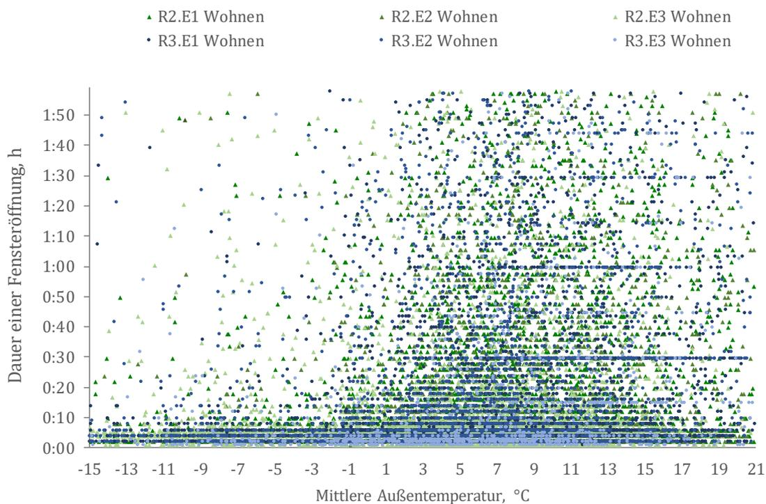
*Abb. 6-21: Gegenüberstellung der Fensteröffnungsdauern im Wohnzimmer für alle Sanierungsvarianten über die mittleren Außentemperaturen während der Heizperiode 2012*
