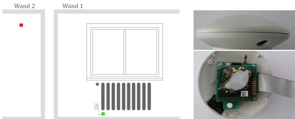
Abb. 4-2: Position (rot) sowie Foto des verbauten Messmoduls in den einzelnen Räumen der Wohnungen des Riegels R2 und R3 (in grün Wilo-Messeinheit)
