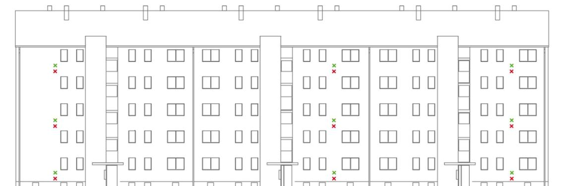
*Abb. 4-3: Anbringungsorte der Wandsensoren am Beispiel der Ostfassade (Sensorposition grün: unter Putz / rot: unter Dämmung)*
