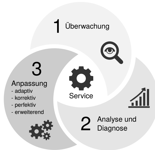
Abbildung 4.4: Kontrollschleife zur Gewährleistung der Servicegüte
