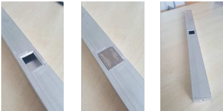
Abb. 6.1: Abbildung eines Messrohres für eine Messung mit flüssigen Medien.
