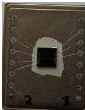
Abb. 5.35: Aufnahme eines gebondeten Chips vor Verkapselung der Bonddrähte.
