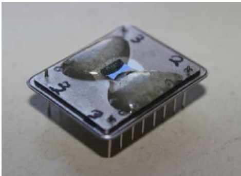
Abb. 5.36: Aufnahme eines gebondeten und verkapselten Prototypen in einem DIL-Package.
