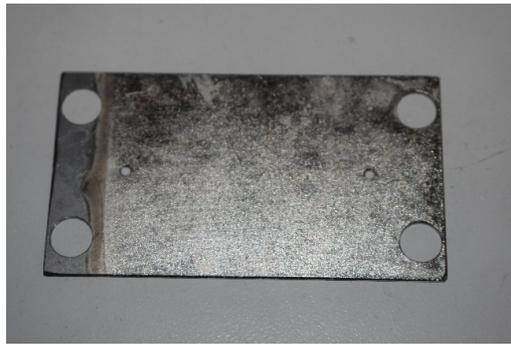
Abbildung E-1: Teilvernickelte Elektrode mit sichtbarem Eisenkern (links).
