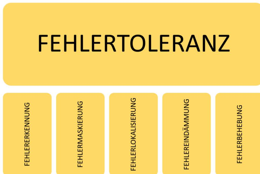
Abbildung 8 - Maßnahmen zur Einhaltung der Fehlertoleranz[30]
