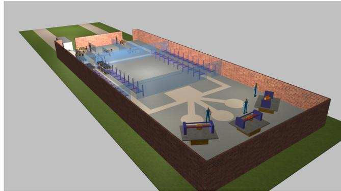
Abbildung 1.2: 3D-Visualisierung eines Simulationsmodells in der Simulationsumgebung AnyLogic 8, das ein Job-Shop-System mit Lagersystemen und Arbeitsstationen umfasst.
