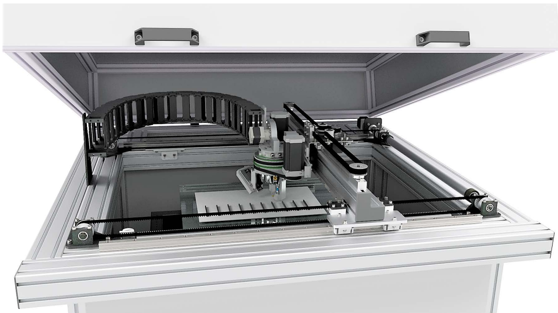
Abbildung 5.2: Rendering des CAD-Modells der Versuchsanlage mit Schutzumhausung
