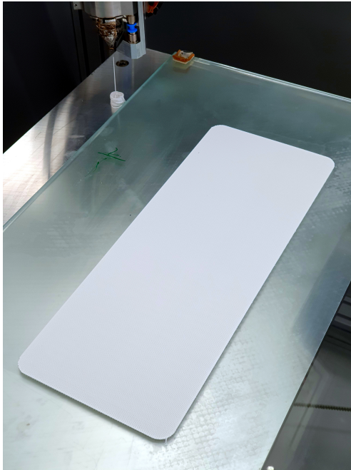
(a) Fertiggestelltes Raft auf dem Glasbett
