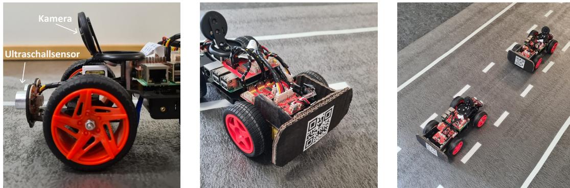
(a) Ultraschallsensor nach unten verlegt und Kamera verbaut.
