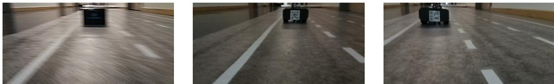
(a) Nach links lenken. Belichtungszeit = automatisch. (b) Nach links lenken. Belichtungszeit = 5 ms. (c) Nach rechts lenken. Belichtungszeit = 10 ms.
