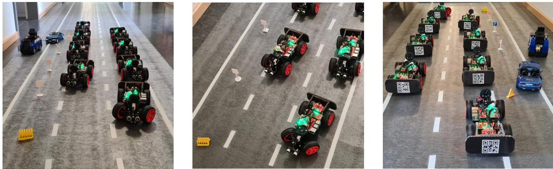
(a) Gefahrenbremsung des Unfallfahrzeugs. (b) Gefahrenbremsung der Modellfahrzeuge in der Nähe. (c) Rettungsgassenbildung der hinteren Modellfahrzeuge.
