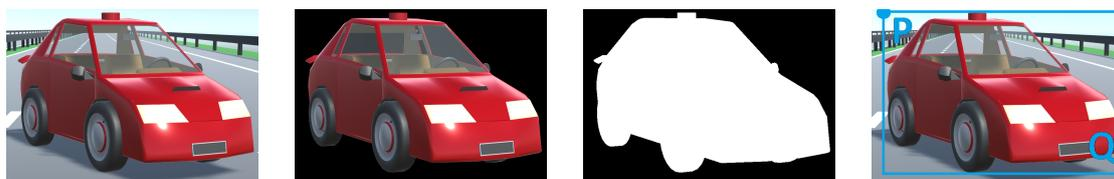
(a) Bild von der ersten Kamera. (b) Bild von der zweiten Kamera. (c) Umgewandeltes Binärbild. (d) Position des Objekts ( $P$  und  $Q$ ).
