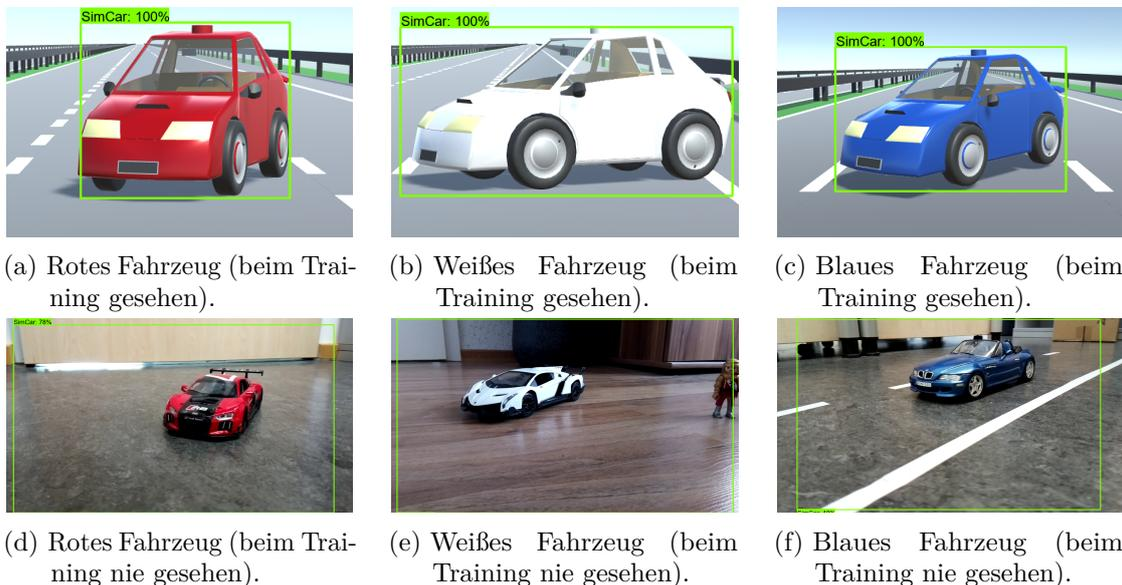
Abbildung 6.18: Sim-zu-Real Übertragung mit dem *SSD MobileNet V2 320 × 320* Modell (Exp. Nr. 2 in Tab. 6.5) trainiert mit dem Datensatz 1 (Sim 1).
