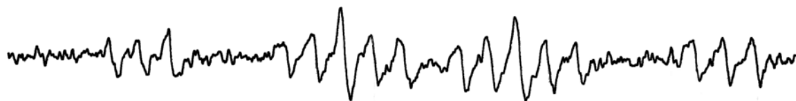
Abbildung 27: ESR-Spektrum bei Oxidation von Isoniazid mit Cer(IV) in Gegenwart von \text{NAD}^+ (26 mM INH, 26 mM \text{NAD}^+ , 28 mM (\text{NH}_4)_2\text{Ce}(\text{NO}_3)_6 , 66 mM DMPO).
