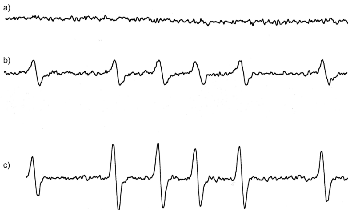
Abbildung 24: ESR-Spektren von 35 mM Met-Gly-NHNHPh * TFA ( 64 ) in Gegenwart von 68 mM DMPO nach 1h, a) als Blindprobe mit O 2 -Behandlung, doch ohne Tyrosinase; b) mit 0.3 mM Cu(OAc) 2 und 3 mM Pyridin unter O 2 -Behandlung; c) mit 33 mM (NH 4 ) 2 Ce(NO 3 ) 6 ohne O 2 -Behandlung.
