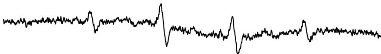
Abbildung 26: ESR-Spektrum des Produkts aus der Isoniazid-oxidation mit Ce(IV) (35 mM Isoniazid, 88 mM DMPO, 33 mM (\text{NH}_4)_2\text{Ce}(\text{NO}_3)_6 ).
